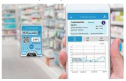
デジタル温度インジケーターTL520は、輸送中の温度の履歴が確認できる温度ロガーです。2-8℃のアラームが設定されているのでワクチンの輸送や保管の温度管理にもご使用頂けます。使用後は、NFC機能(近距離無線通信)と専用Appを利用し、使用中の温度履歴、最高温度、最低温度、平均温度などを簡単に確認することが可能です。
