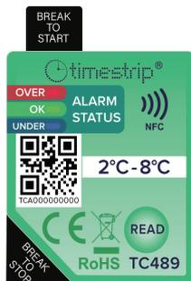
デジタル温度インジケータTC489は、コールドチェーン2-8°C輸送中に温度逸脱がおこっていないかを確認できる温度管理ツールです。本体に搭載された3色のLEDライトによって輸送・保管中の閾値越えの有無を誰でも簡単に確認することができます。またLED表示に加え、TC489では使用後にNFC機能(近距離無線通信)を利用して、アラームの詳細状況をレポート形式で確認することも可能です。
